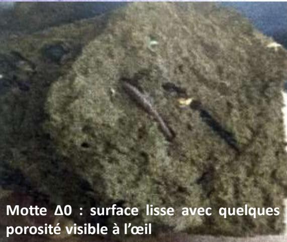
Motte Δ0 : surface lisse avec quelques porosité visible à l'œil
