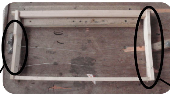
Gabarit avec excentreur en pression et fil détendu
