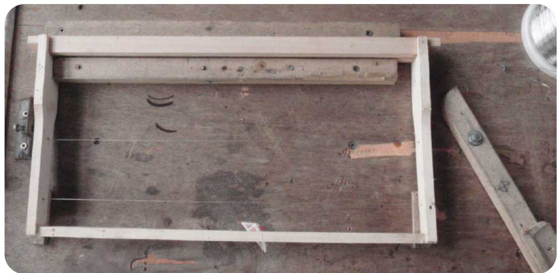
Gabarit avec excentreur en position relâchée et fil tendu
